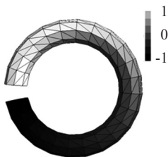
Рисунок 1. Распределение заряда по поверхности наночастицы в форме разомкнутого кольца для магнитной моды. Темный цвет соответствует отрицательному заряду, светлый – положительному
